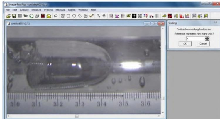
Figura 2 – Calibração do software “Image Pro Plus”
