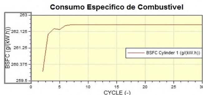
Figura 2 – BSFC para o diesel puro.
